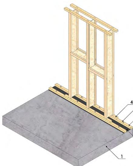
Каркас стен 1 этажа монтируется на предварительно установленную и выровненную по горизонтальному уровню нижнюю обвязку.
